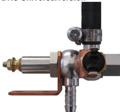
Einbau vor dem Filtereingang in die Kraftstoffleitung
