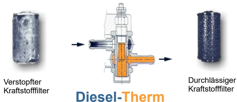
**Diesel-Therm** verhindert durch Erwärmen des Kraftstoffes mittels eines kleinen Heizsystems, das vor dem Filtereingang montiert wird, auch bei extrem niedrigen Temperaturen das Verkleben der Filterporen. Die energiereichen Paraffinkristalle werden durch die Wärme in sekundschnelle aufgelöst und der Kraftstoff passiert den Filter, als ob es Sommer wäre.
